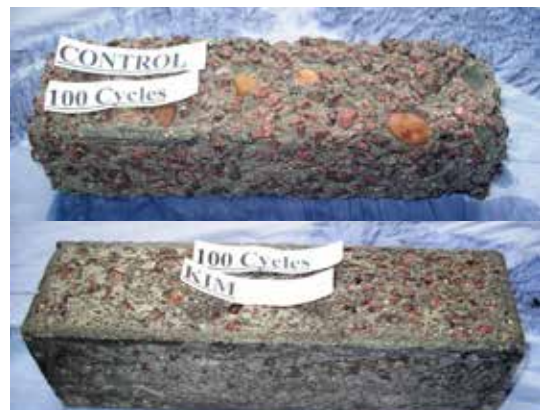
经过100个冻融周期后的控制混凝土与KIM处理过的混凝土。
