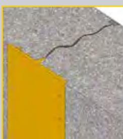
Kryton裂缝引导止水带能形成一种可控裂缝,随后通过一种外用止水带工法来引入Krystol技术,确保永久防水保护。
